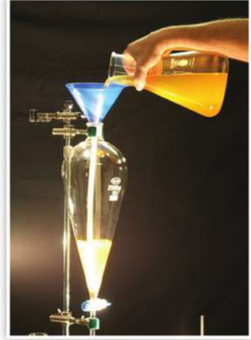
شكل (٣٩): قمع الفصل يستخدم لفصل السوائل غير المتجانسة.
